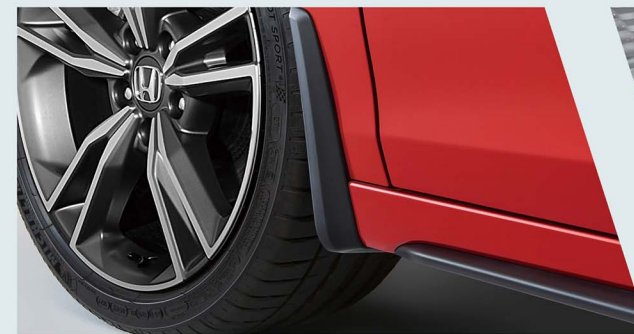
▮ 擋泥板（霧面黑色） 依循車身線條設計，減少行駛中碎石及泥水噴濺車身，保持愛車乾淨。
