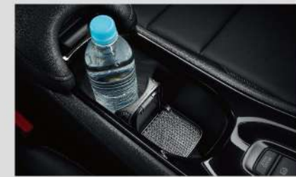
兩階段深淺設定杯架 (深層設定狀態)
