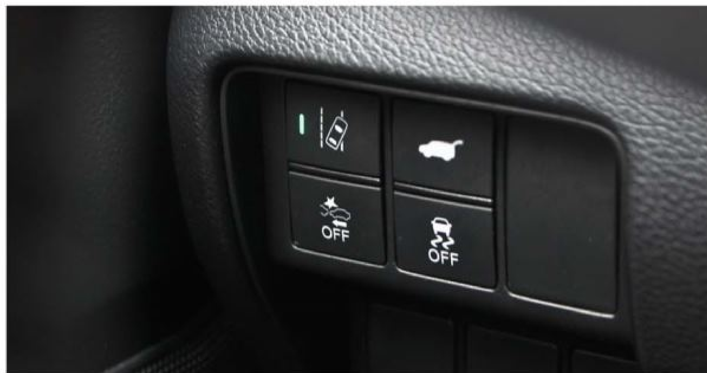
LKAS 車道維持輔助系統可自動提供轉向輔助，協助將車控制在車道中央。
