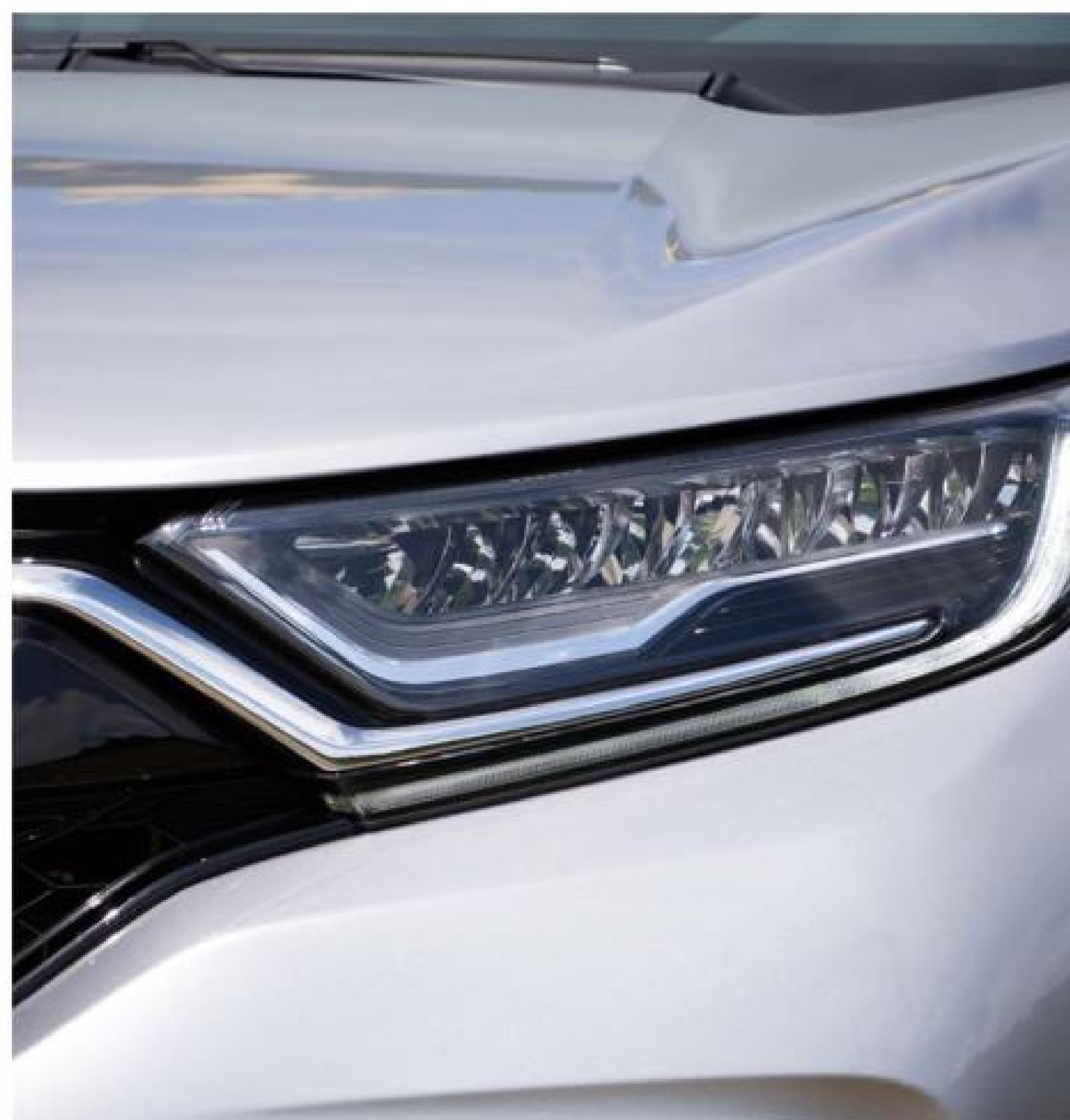
整合在頭燈內的方向燈改為序列式動態燈光。
