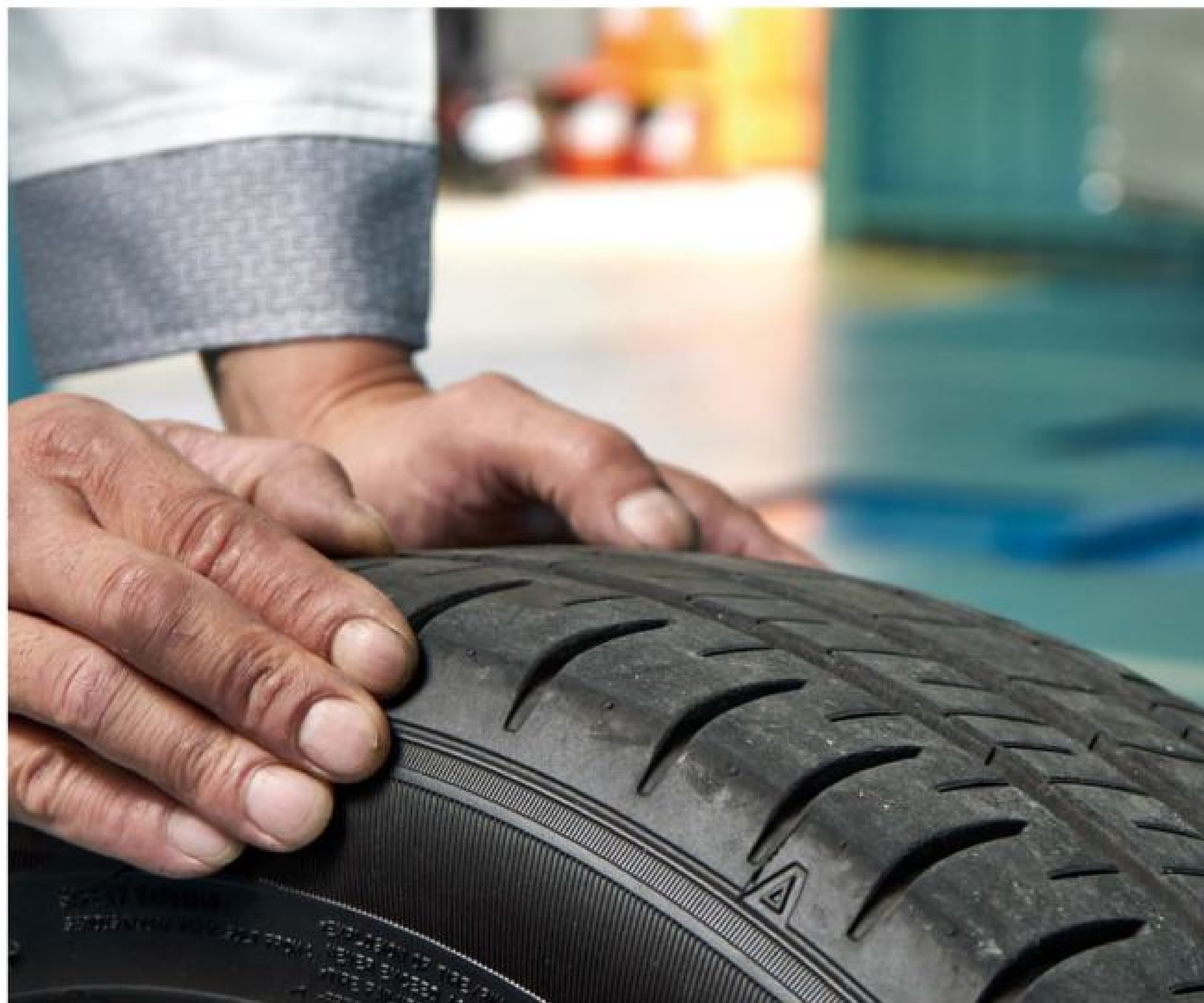
每週檢查一次胎壓並補足，每個月檢查一次胎紋磨耗程度。
