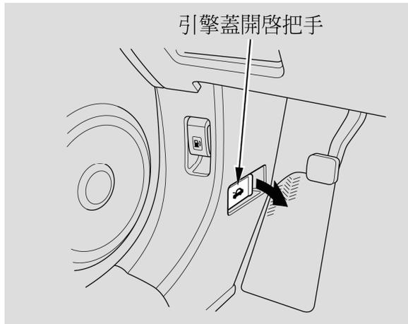
1. 停好車輛，並刹緊駐車剎車。拉起儀錶板下方角落的引擎蓋開啓把手。此時，引擎蓋會稍微的彈起。
