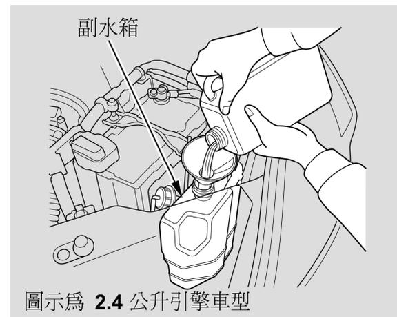
6. 將冷卻液注入副水箱內。使液面高度位於 **MAX** (上限) 與 **MIN** (下限) 之間。再蓋回蓋子。
