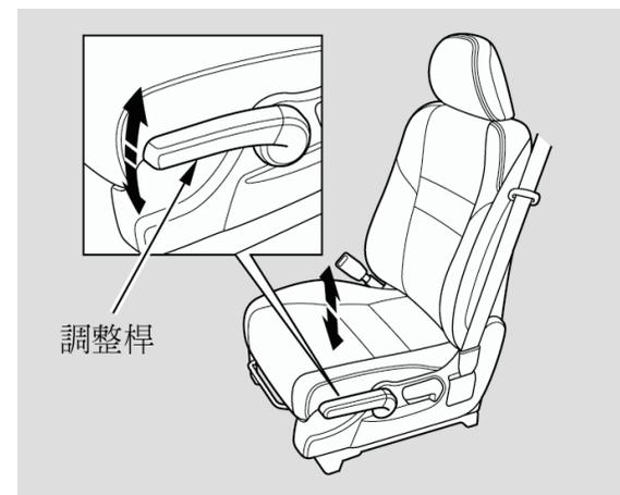
駕駛座椅的高度是可調整的。若要升高座椅，請將位於椅墊外側的調整桿反覆向上拉即可。要降低座椅時，請將調整桿反覆向下壓。
