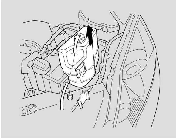
要更換左邊燈泡，請將引擎冷卻液副水箱從其固定座拉開以便將其拆下。
