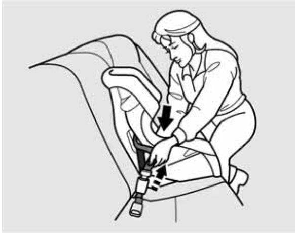
要使用安全帶的腰帶部分固定兒童安全座椅在後座的中央位置，依照兒童安全座椅製造商的說明，將安全帶穿過兒童安全座椅，然後將安全帶舌板插入帶扣內。
