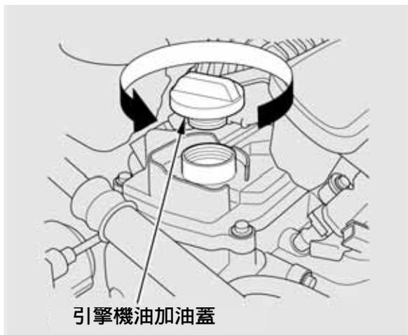
轉開並取下下搖臂蓋上方的引擎機油加油蓋。慢慢倒入機油，小心不要溢出。若有溢出，馬上擦拭乾淨。溢出的機油會損壞引擎室的組件。
