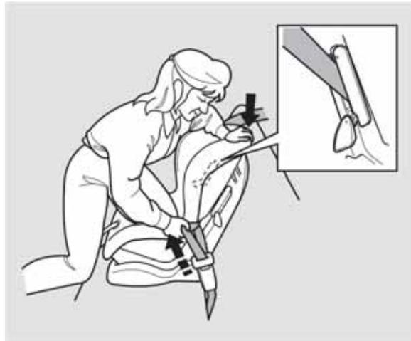
4. 在確認該安全帶已鎖緊之後，拉住靠近帶扣的肩帶部份，並向上拉緊以消除腰帶鬆弛的現象。記住，倘若腰帶的部份沒有綁緊，此兒童安全座椅將不會穩固帶部份未拉緊，則無法固定兒童安全座椅。
