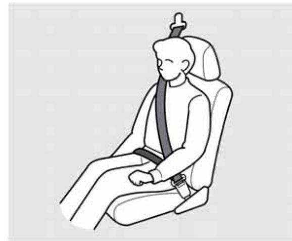
將安全帶的腰帶部分儘量放低以繞過您的臀部，然後將肩帶部位往上拉讓使腰帶部分正好貼身。這樣可使堅固的盆骨承受衝擊力，降低內傷的發生。
