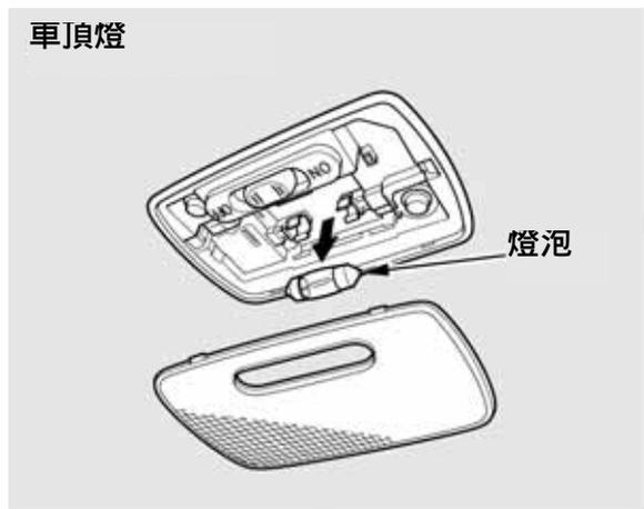
1. 以指甲銼或小型平口螺絲起子，小心撬開鏡片邊緣，拆下燈總成。
