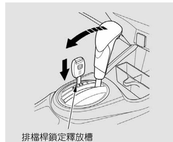
6. 將鑰匙從排檔桿鎖定釋放槽中取出，然後重新蓋上蓋板。請確定蓋板的凹口朝向左側。踩下煞車踏板，並重新啟動引擎。
