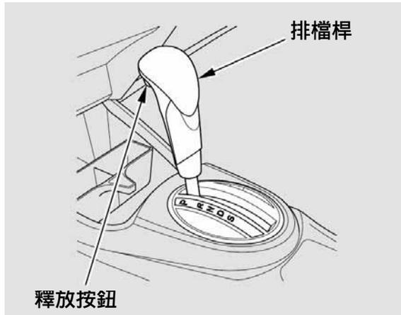
要從 P 檔換到任何檔位時，請完全踩住煞車踏板並按下排檔桿上方的釋放鈕，然後移動排檔桿。在點火開關處於 LOCK(0) 或 ACCESSORY (I) 位置時，無法從駐車 (P) 檔移出。
