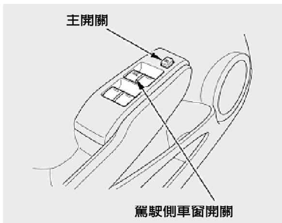
要升降任一車窗時，請將點火開關轉到ON(II)位置。要打開車窗時，輕輕地壓住開關。當您想要停止電動窗時將開關釋放。將開關往回拉住可以關閉車窗。
