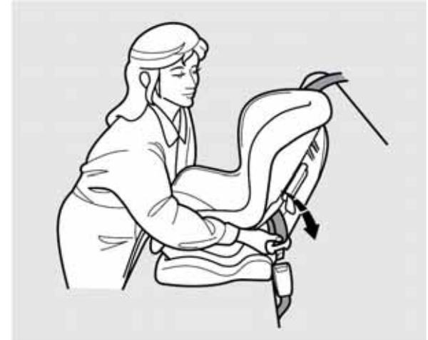
2. 依照兒童安全座椅製造商的說明，將安全帶穿過兒童安全座椅，然後將安全帶舌板插入帶扣內。
