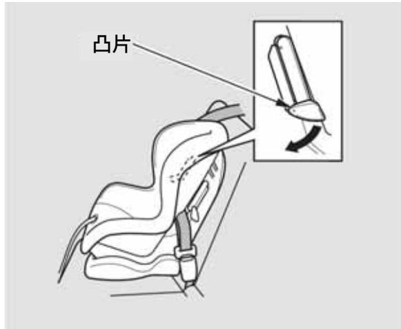
3. 壓下凸片。將安全帶的肩帶部份穿過兒童安全座椅的側邊細縫。
