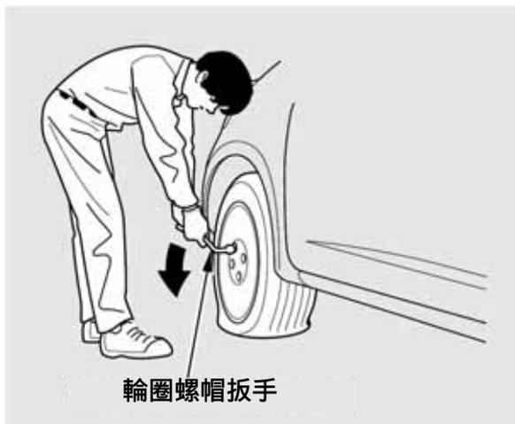
8. 使用輪圈螺帽扳手將每個輪圈螺帽鬆開 1/2 圈。
