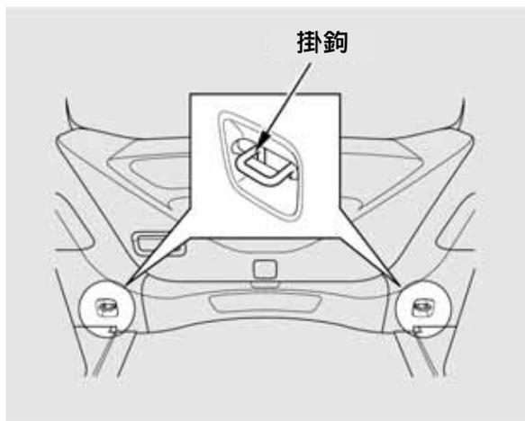
行李廂地板的掛鉤可讓您將物品固定在後方。行駛前必須確認所有儲放的物品都牢牢的固定。
