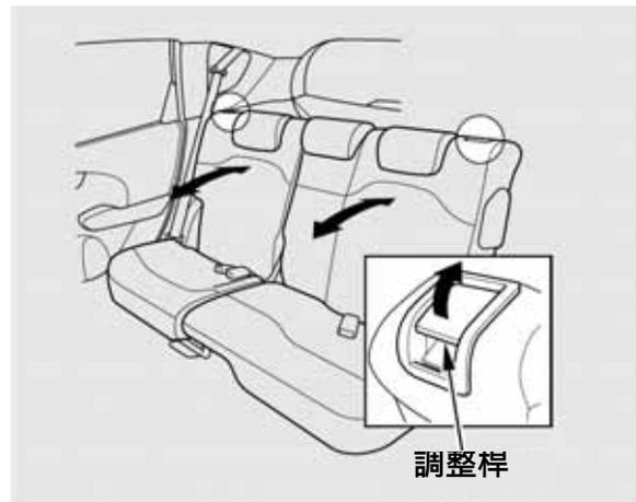
您可以單獨的調整後椅背的角度。要改變椅背角度時，將椅背外側的開啟桿往上拉即可。
