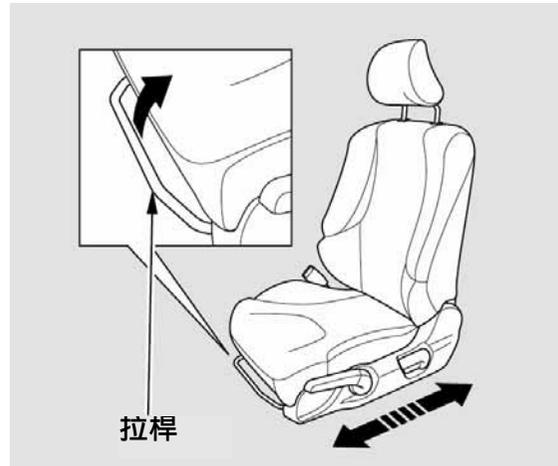
要前後調整座椅時，應將椅墊前緣下方的拉桿向上拉。將座椅移到想要的位置後，放開拉桿。試著移動座椅，以確認是否鎖到定位。
