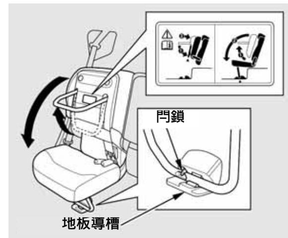
要將座椅墊恢復到原來的位置時，首先必須確認地板上沒有物品，然後將座椅腳架完全往上提，並使用您的雙手將座椅墊緩慢地往下壓。使座椅腳架卡入地板導槽中。當座椅腳架的位置安裝正確時，門鎖會彈出。
