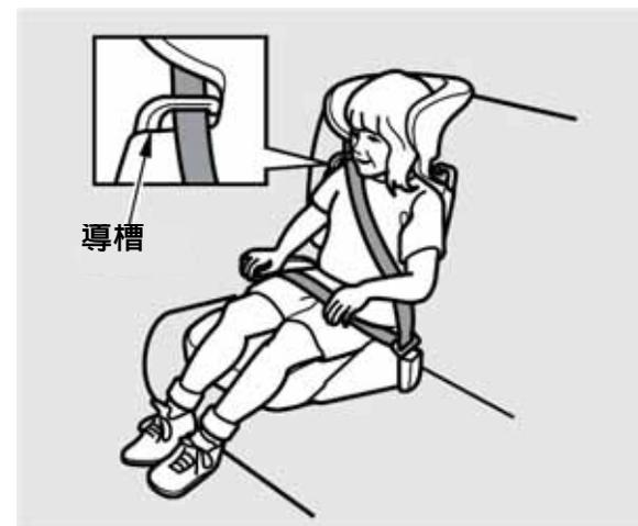
某些輔助坐墊有靠背可供使用。將靠背安裝到輔助坐墊上並根據輔助坐墊製造廠商的指示來依車輛座椅調整輔助坐墊靠背。請確定安全帶正確穿過靠背肩部的導槽且安全帶沒有觸及或越過兒童的頸部（請參閱14頁）。
